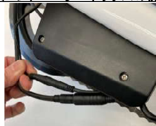
③バッテリー底部 コントローラーボックス下側のボックスの割れ目からコード類を引き出します。
