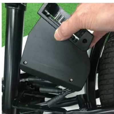
⑥コントローラーボックスをフレームから引き抜きます。
