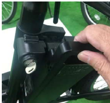
②バッテリーのハンドルを手前に倒し引き抜きます
