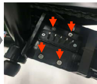
⑤コントローラーボックス上部 フレームに取付のM4+皿ネジ 4点を外します。
