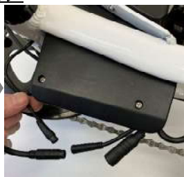
④引き出した前側よりのBBセンサーコード、4本束ね中継コード2本のコードジョイントコネクタを引き抜き外します。さらに後方チェーンステア下側よりのモーターコードのジョイントを外します。
